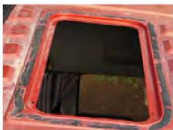
1. Снять люк и его прокладку или вырезать отверстие в крыше
